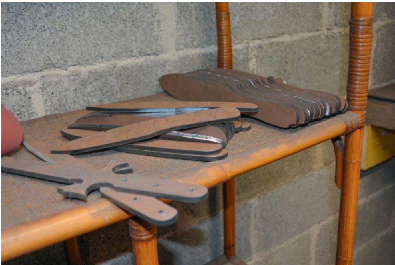
Les couteaux sont découpés au laser. Le lanceur leur donne leur forme dans son atelier.
